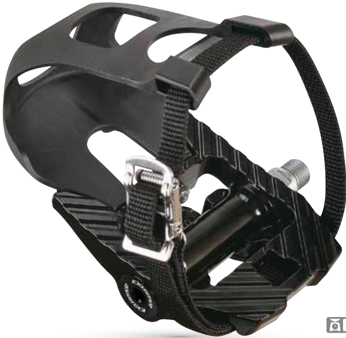
SIDE A: Platform + Toe clip attachable.
